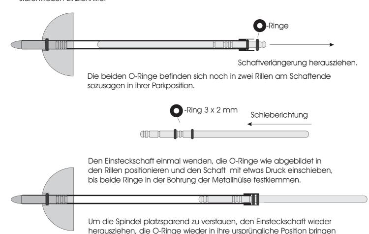
Dies ist eine schematische Darstellung. Details können von der gelieferten Spindel abweichen. Weitere Hilfe finden Sie in der Anleitung: Das Klemmringssystem.
